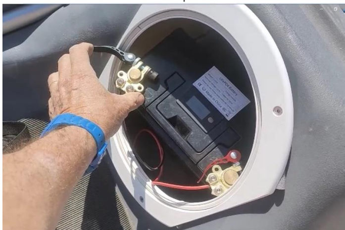
Batterie dans un compartiment étanche
